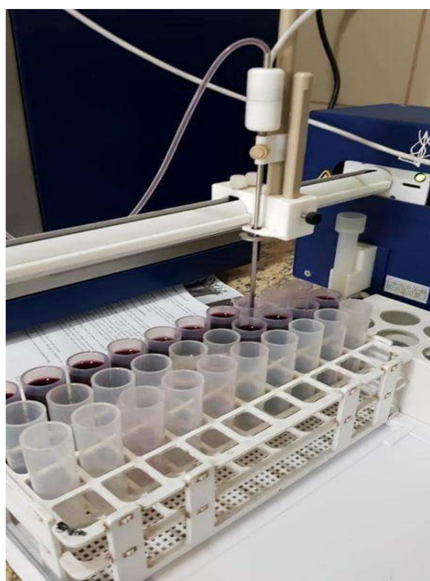
Figura 1: Análise do vinho no equipamento WineScanTM (FOSS®). Unipampa, 2026.
