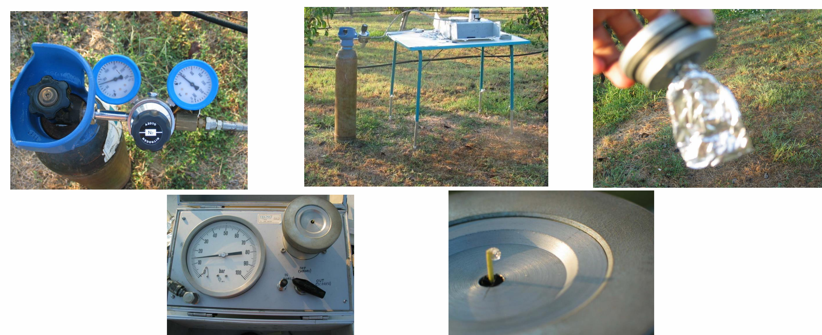
Figura 1: Bomba de Scholander e sequência da leitura de fluxo xilemático. UFFS, (2026).
